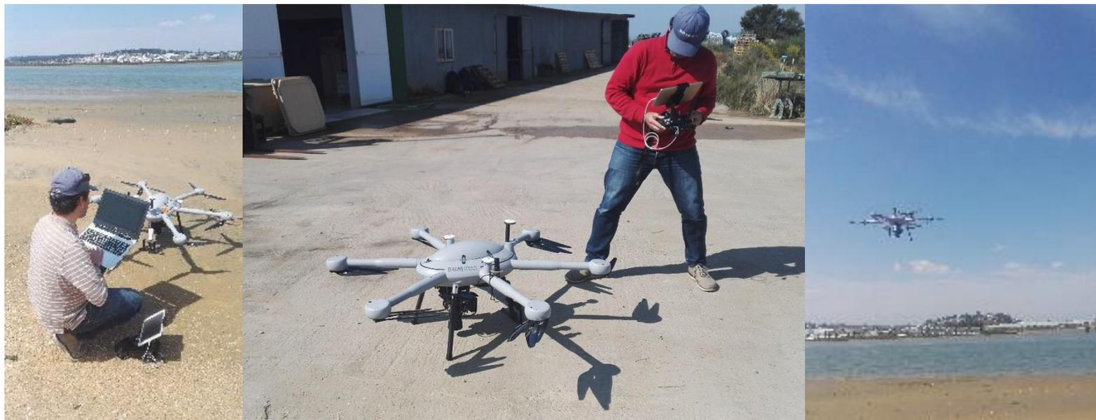
Vuelo a 200m de altura realizando fotos continuadas con un solapamiento del 70% entre ellas y **una resolución de 3 cm por pixel** sobre los bancos naturales de ostiones del rio Piedras
